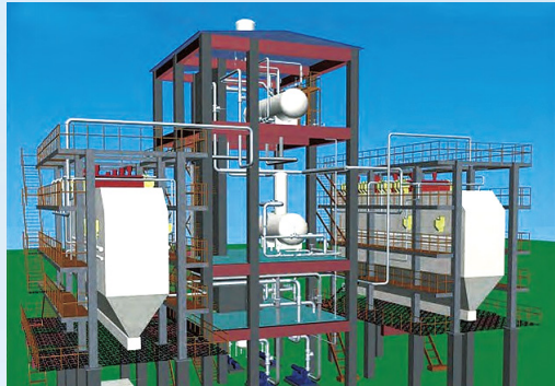
葫芦岛转炉余热锅炉三维设计
